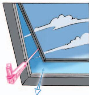
In Gebäuden öffnen und schließen RA Linearantriebe schwierig zugängliche Fenster und Dachluken.
