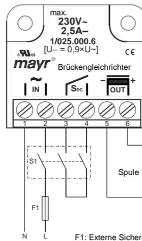
Der Stromkreis wird zwischen Gleichrichter und Spule sowie netzseitig unterbrochen. Das Magnetfeld baut sich sehr schnell ab. Dies bewirkt einen schnellen Anstieg des Bremsmoments.
