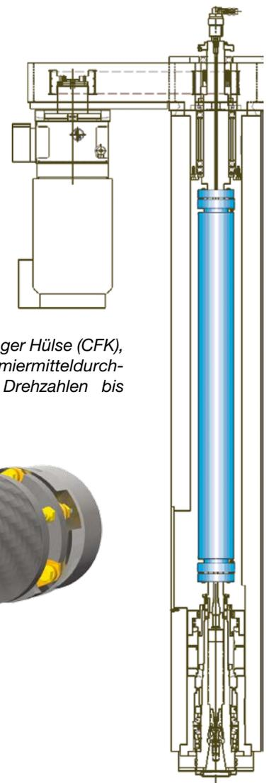
ROBA®-DS mit 2,5 m langer Hülse (CFK), mit integrierter Kühlschmiermitteldurchführung, geeignet für Drehzahlen bis 10.000 min<sup>-1</sup>.
