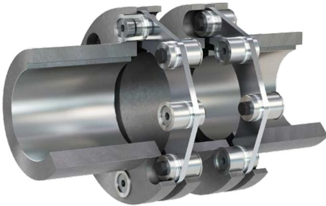
Bei der ROBA<sup>®</sup>-DS mit Konusanbindung wird das Lamellenpaket formschlüssig mit den Naben, Flanschen oder Hülsen verbunden. Außen konische Bolzen werden durch Spannschrauben in kegelförmige Bohrungen der Anbauteile und die Bundbuchsen der Lamellenpakete gezogen. Durch die Konusform entstehen Kräfte, welche die Bundbuchsen und Anbauteile radial elastisch aufweiten und so eine spielfreie Anbindung des Lamellenpakets garantieren.
